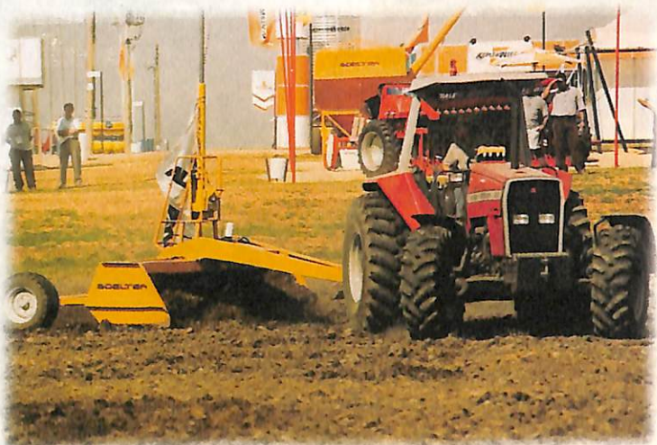
Niveladora a laser: deixa o leito do solo uniforme
