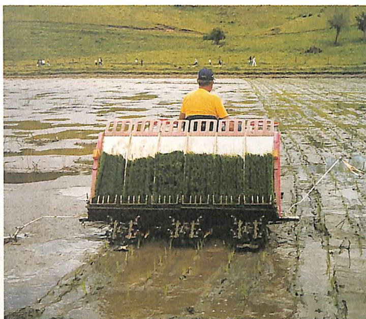
Transplante mecânico de mudas de arroz: aqui começa a produção de sementes de qualidade, livre de invasoras
