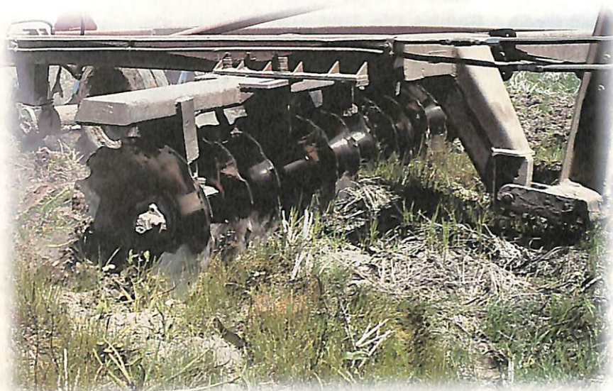
Arado de discos recortados: indicado para áreas com grande volume de massa verde
