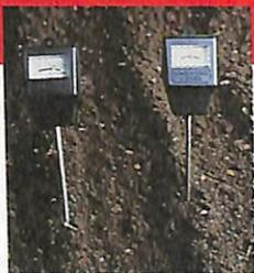
**Medidor de Umidade** (importado). Aparelho de grande utilidade e praticidade. Mede a umidade da terra, determinando se há ou não necessidade de se colocar mais ou menos água. Muito útil para folhagens, estufas e para áreas irrigadas, indicando o momento correto de molhar as plantas ou lavouras. Muito fácil e prático de ser usado. Medição instantânea. Vinte centímetros de haste. Funciona sem pilhas ou baterias. **COD. 641 - R\$ 49,00**
