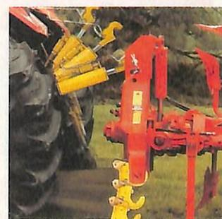
**É O NOVO SISTEMA DE ACOPLAMENTO RÁPIDO TRATOR COM IMPLEMENTOS**
