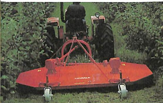
A roçadeira deslocável Lavrale, de Lavrale Máquinas Agrícolas, de Caxias do Sul/RS, possui estrutura de chapa dobrada e reforçada por ferro tipo cantoneira.
