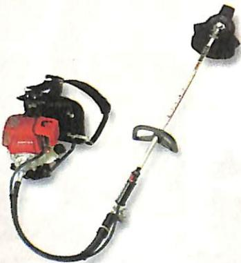
Movida à gasolina, a roçadeira portátil Honda UMR 431 (lançamento mundial da empresa japonesa em abril) possui tecnologia dos motores quatro tempos, que garantem ao produto baixo consumo de combustível. Possui eficiente sistema de lubrificação do motor com bomba rotativa, e não precisa adicionar óleo na gasolina. O equipamento opera em qualquer posição. **Moto Honda da Amazônia Ltda., rua Sena Madureira, 1500, CEP 04021-001, São Paulo/SP, fone (011) 576-5091.**
