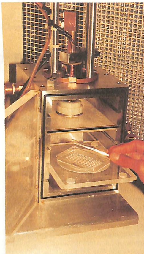
Gun, aparelho de bombardeamento: o mais moderno sistema para transferência de gens
