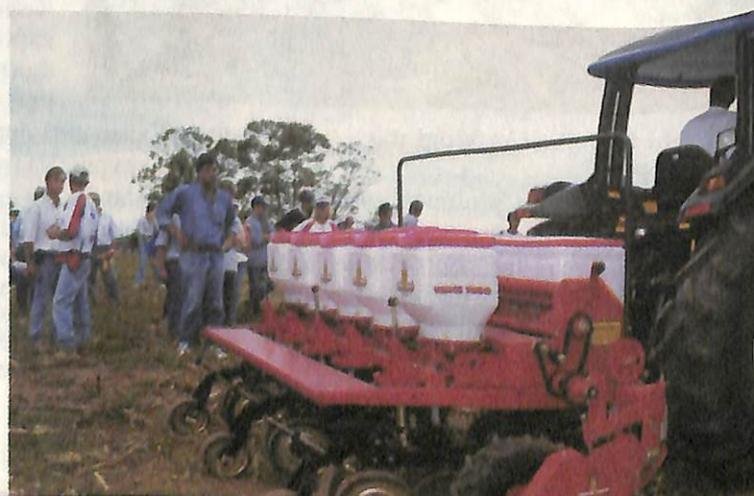
A Semeadora Semeato Múltipla SSM 23 é uma máquina que se adapta a diferentes culturas e sistemas de plantio. É um equipamento eficiente tanto no plantio de grãos graúdos como no plantio de grãos miúdos e pastagens. Uma máquina de uso múltiplo para as diferentes culturas. A distribuição de fertilizantes da SSM 23 é realizada através de rosca sem-fim ou rotores dentados.
