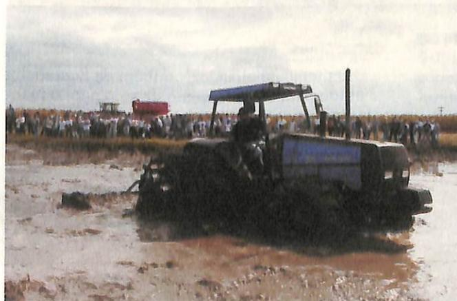
O Valtra-Valmet 985 S 4X4 é equipado com motor Valmet turbo alimentado que desenvolve a potência de 105cv, com alto torque a baixas rotações, o que garante um alto rendimento e um baixo consumo de combustível. Tem sistema hidráulico de alta vazão e capacidade de levantar de 2590kgf, vem com caixa de câmbio sincronizada e um exclusivo sistema Multi Torque, que oferece 16 velocidades à frente, oito de ré, proporcionando um ótimo escalonamento de marchas.
