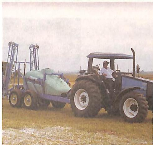
O Montana 2000 — SLH 1428 é equipado com barras de 14 metros/28 bicos com controle hidráulico de levante e abertura das barras, equipado com bicos antideriva, válvulas antigotejo e filtro de linha, tanque de 2000 litros em polietileno com sistema de lavafrasco com reservatório de 110 litros de água limpa. Com sistema de barras auto-estável, com rodado truck (tanden) indispensável para terreno arroseiro, bomba 80 litros por minuto, com bomba hidráulica individual acionada pela tomada de força.
