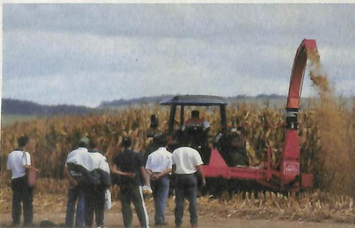
O Silo Press 60cv, da Boelter, é utilizado para o armazenamento de silagem ou grãos úmidos. Compacta forragem verde ou grãos com umidade de 35% em bolsa plástica de 60 metros de comprimento em qualquer ponto da propriedade, sem necessidade de instalações fixas. Grande economia de mão-de-obra, redução nas perdas de silagem, alta qualidade nutricional da silagem, facilidade de interrupção do trabalho em função de chuvas.
