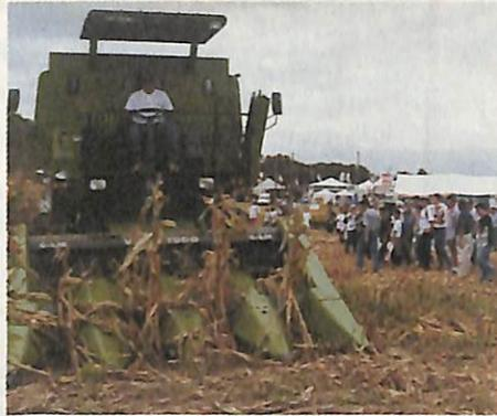
A plataforma de milho, MF 3640 da Vence Tudo, é acoplada em qualquer marca de colheitadeira nacional, fabricada de três a 10 linhas, espaçamentos variáveis de 0,50cm a 110cm. Ângulo de 20°, que elimina a perda durante a colheita. Caixas de transmissão em aço modular, engrenagens cônicas banhadas a óleo que permitem mais durabilidade e menos ruído. Aletas de fácil substituição, limitador de torque individual por linha, rotação regulável de 480rpm a 1100rpm.
