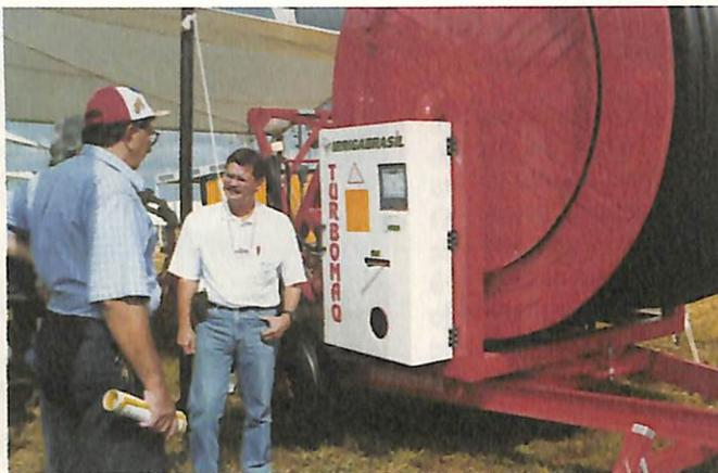
baixa pressão, entre dois a três quilos por centímetro quadrado, e é mais indicada para lavouras de batata, milho, feijão, similar ao pivot linear e substitui o aspersor tipo canhão. O que na prática significa sofrer menor ação do vento, alcançar maior rendimento de irrigação e um consumo de energia menor.
