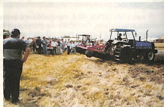
A lâmina niveladora reversível da Scarabelot é usada para nivelar terrenos para plantio pré-germinado, fazer reparos em estradas. Trabalha com oito posições horizontais diferentes frente e verso.
