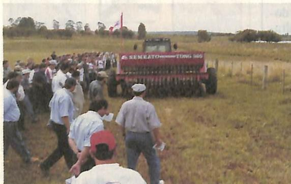
As semeadoras TDNG 320, da Semeato, são máquinas destinadas ao plantio direto, cultivo mínimo e plantio convencional de grãos miúdos. Possuem rodado articulado que mantém o pneu sempre em contato com o solo, evitando falhas no plantio ao semear sobre terreno irregular (exemplo Taipa). A distribuição de sementes é realizada por rotor acanalado helicoidal e distribuição de adubo através de rosca-sem-fim ou rotor dentado.
