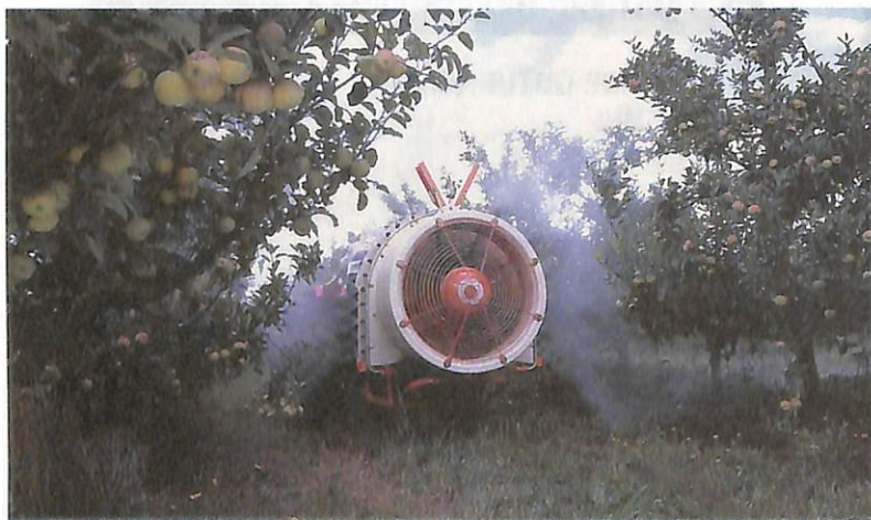
Canhão atomizador para 2 mil litros tem pneus de boa flutuação, alta pressão e vazão para a calda poder penetrar na página inferior das folhas
