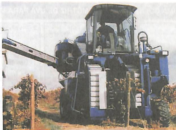
Colhedeira automotriz de uva com descarregamento lateral e trabalhando a cavaleiro na espaldeira
