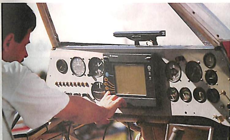
Tecnologia embarcada: sistema DGPS AG-NAV orienta o piloto para uma aplicação de precisão
