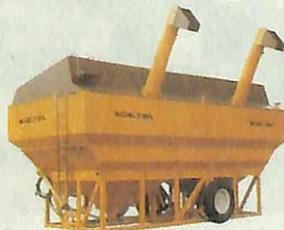
causada pela ação dos produtos químicos. A rosca transportadora também de polipropileno, que também não causa danos às sementes a serem tratadas. Rosca em módulos de pequeno tamanho, com fácil reposição. Opcional: terceira caixa para micronutrientes. **Bandeirante Ind. e Com. de Máquinas Ltda, Av. Brasil Leste, 2222, CEP 99050-000, Passo Fundo/RS, fone (54) 313-2844, fax 313-3948, e-mail: bandeirante@via-rs.net.**
