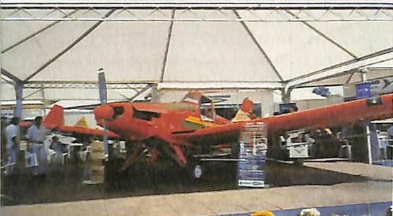
O Ipanemão 2000 vem com um novo sistema de pulverização eletrostática – algo realmente revolucionário no setor. Esta tecnologia – que usa cargas elétricas para levar as gotas de pulverização
