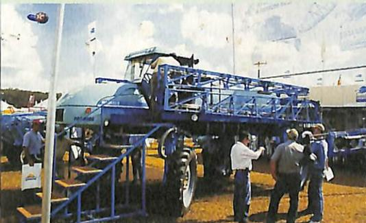
O pulverizador automotriz modelo Parruda MA 3025H, da Montana, reúne modernidade, robustez e desempenho. Equipado com motor MWM turbo de 135cv, o pulverizador possui transmissão
