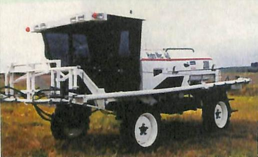
O pulverizador automotriz Gafanhoto 2000 Hydro-Mec. 4x2 tem tração hidro-mecânica 4x2, barra de pulverização frontal autonivelante de 18m, velocidade de trabalho de 17km/h, tanque de 2 mil litros, controlador de vazão computadorizado, bomba centrífuga de 350
