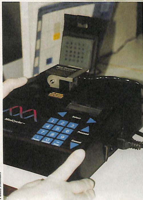
O aparelho termociclado, usado no processo de transgênia, amplia as seqüências de DNA da planta
