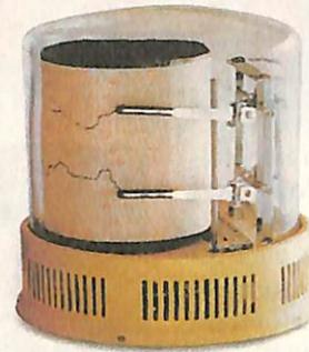
*Termohigrógrafo: aparelho que foi substituído pela estação meteorológica automatizada*
