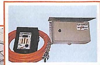
Os modernos sistemas de termometria compreendem linhas que passam pelo digital portátil, portátil computadorizado e computadorizado com controle de aeração
