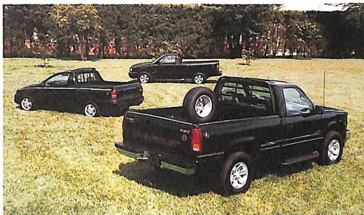
Chevrolet Silverado D20 vem com travas elétricas, alarme com acionamento remoto, vidros e espelhos elétricos e rodas de alumínio. As pickups S10 cabine simples, com motorização 2,4 litro e
