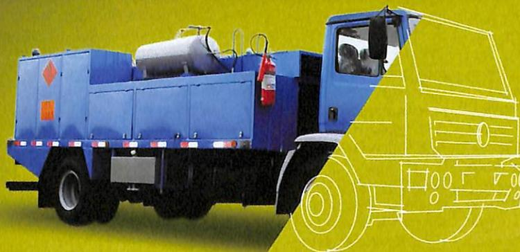
**Comboio para abastecimento e lubrificação de máquinas**
