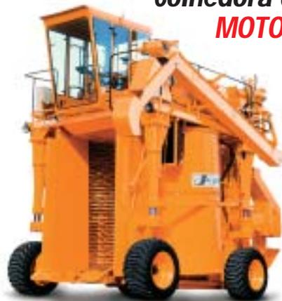
A Jacto está no mercado com uma nova geração da colhedora de café automotriz. A *K-3 Challenger* possui rodas motorizadas e pneus mais largos e de alta flutuação, que possibilita um deslocamento mais suave, garantindo baixa compactação do solo. Cada roda possui, acoplado em seu centro, um cubo-motor hidráulico, que a faz girar e aumenta em 100% a velocidade de traslado da máquina, atingindo até 15 km/h. Disponível nas versões 4X4 e 4X2.
