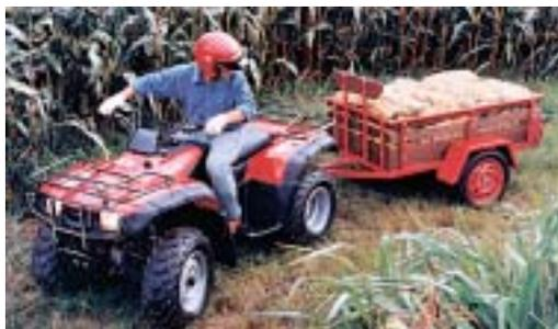
o modelo possui pneus largos e de baixa pressão, que ampliam a capacidade de tração, reduzem o efeito de compactação e aumentam o vão livre em relação ao solo.
