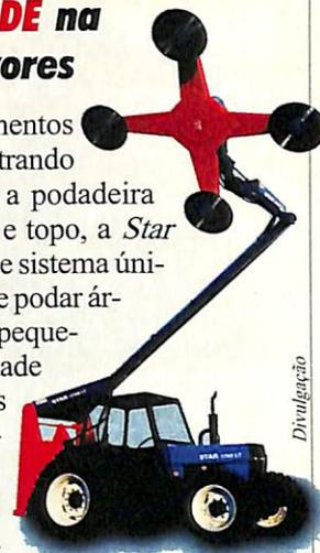
Quando acoplada ao trator, fica balanceada para que o peso maior fique distribuído sobre as rodas de tração. As quatro grandes serras circulares começam a operar antes do início da rotação da estrela, garantindo um corte limpo e preciso.
