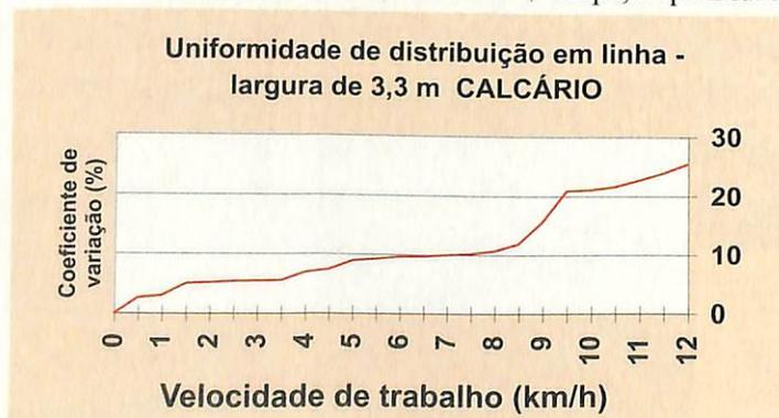
Figura 1 – Uniformidade de distribuição para máquina em linha
