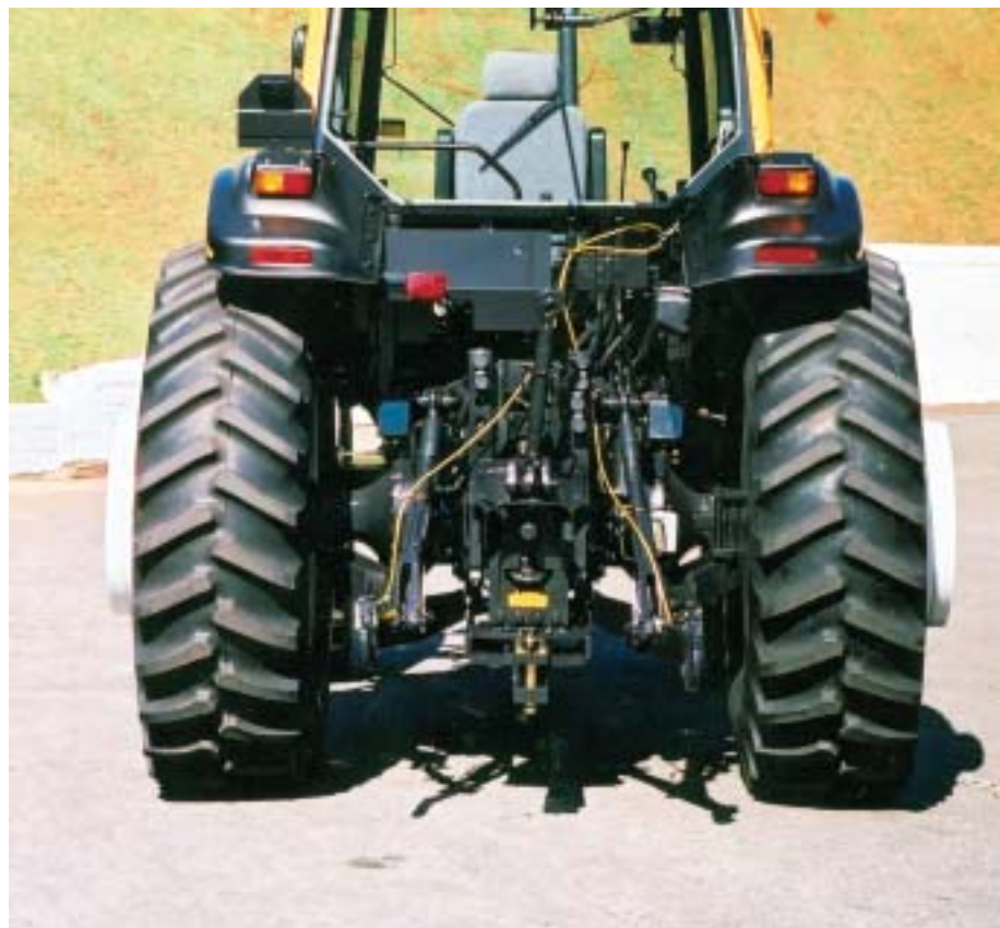
O desgaste de 80% na altura das garras compromete a eficiência da tração e indica a necessidade de substituição dos pneus, especialmente quando o trator perder a aderência ao solo
