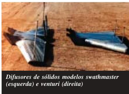
Difusores de sólidos modelos swathmaster (esquerda) e venturi (direita)
