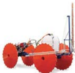
Microtrator com pulverizador, semeador e adubador tração 4x4
