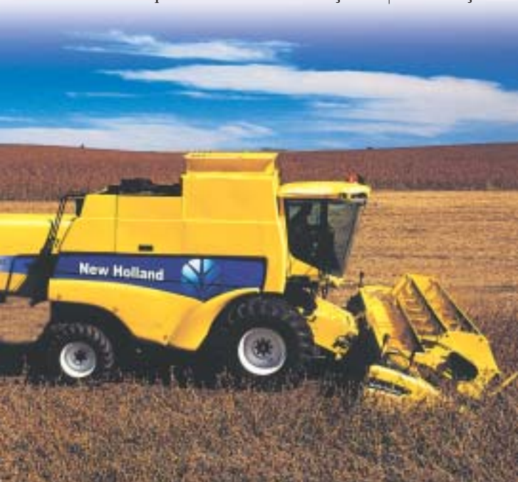
Diferencial da CS660: tanque graneleiro de 9 mil litros reduz o número de paradas para descarregar, agilizando a etapa da colheita
