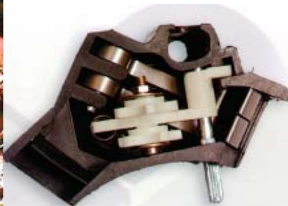
*Câmara de individualização e ejeção de sementes em dosadores do tipo discos alveolados e tubulação de descarga na saída de um dosador de sementes a vácuo*
