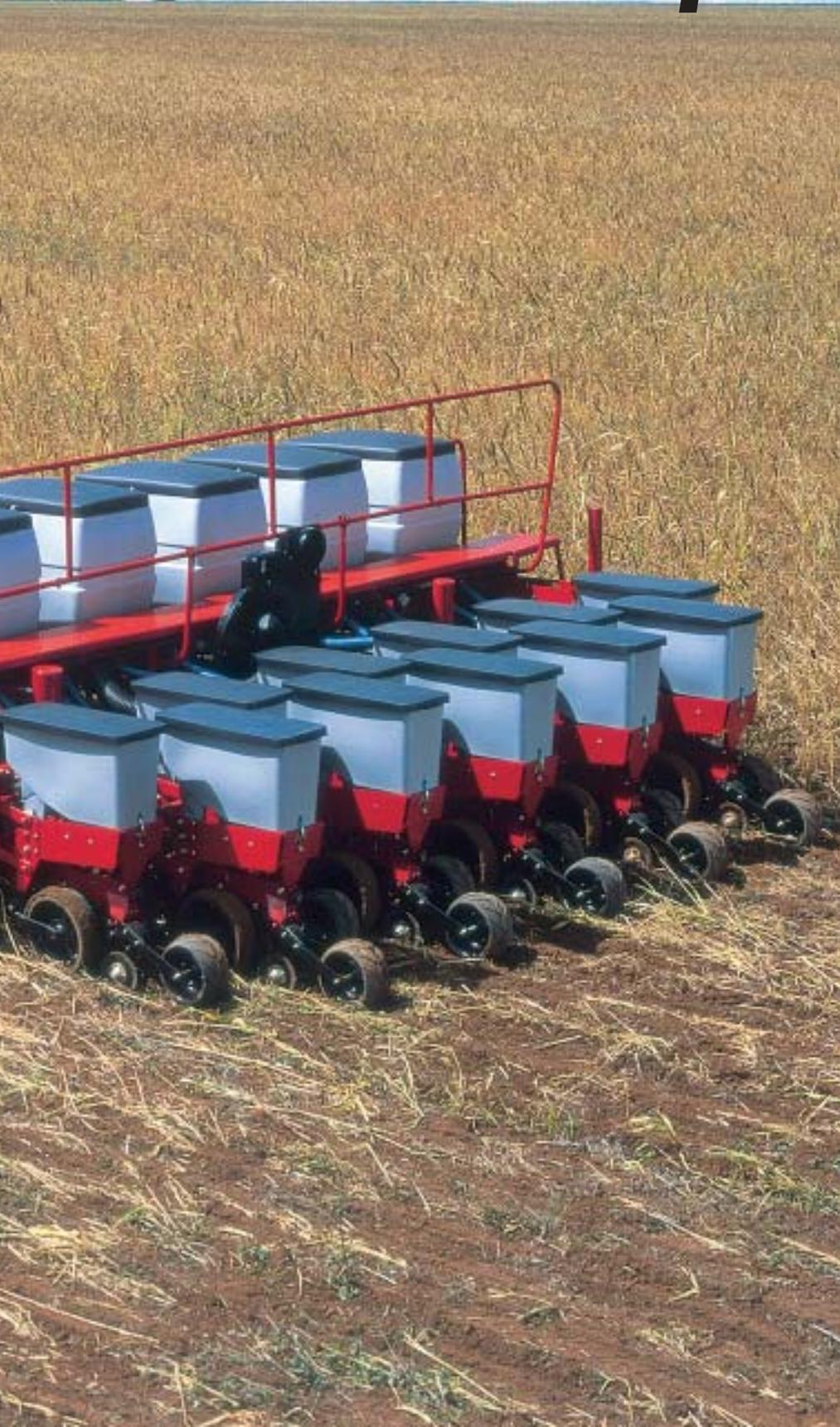
semeadoras devem cortar a palha sobre a superfície do solo, evitando, assim, embuchamento nos demais componentes. Devem abrir um sulco para depositar o fertilizante na dosagem, posição e profundidade adequada.
