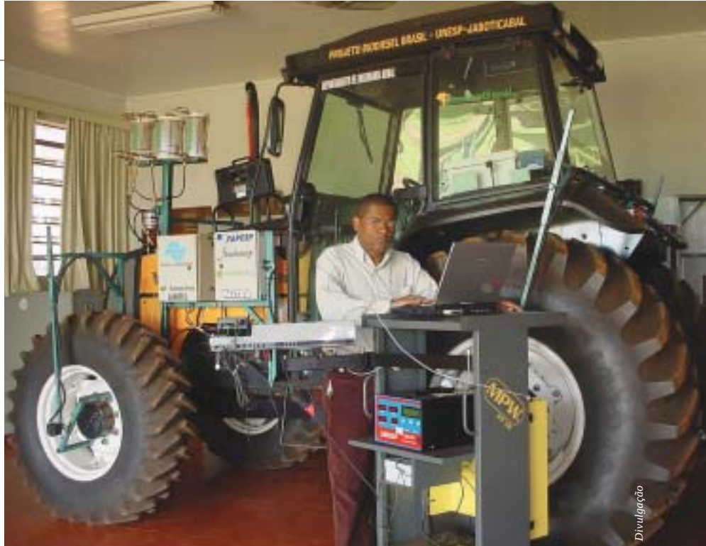
Lopes, da Unesp, coordena há três anos estudo com um trator de 100cv, que vem sendo testado com biodiesel feito a partir de diversas culturas
