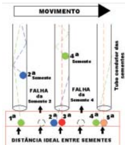
Figura 1 – Falhas na distribuição de sementes por rebatimento na parede dos tubos condutores
