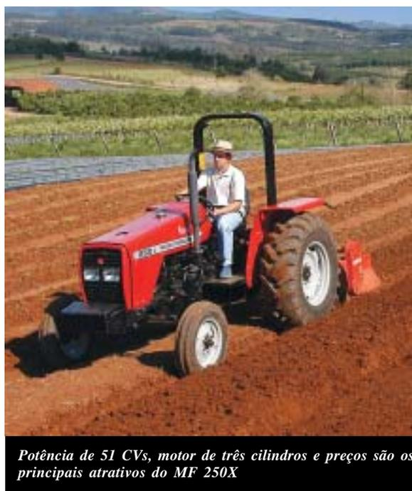
Potência de 51 CVs, motor de três cilindros e preços são os principais atrativos do MF 250X
