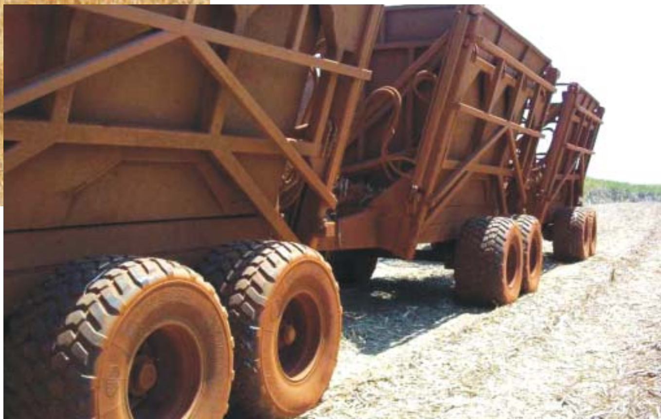
Traçado diferenciado do Cargo Xbib, da Michelin, favorece o trabalho de semeadura e o deslocamento
