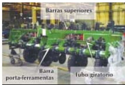
Figura 1 - Estrutura com rodados internos e sistema de levante do tipo tubo giratório acionado por um pistão
