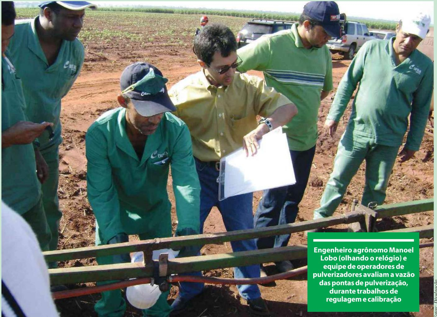
Engenheiro agrônomo Manoel Lobo (olhando o relógio) e equipe de operadores de pulverizadores avaliam a vazão das pontas de pulverização, durante trabalhos de regulagem e calibração
