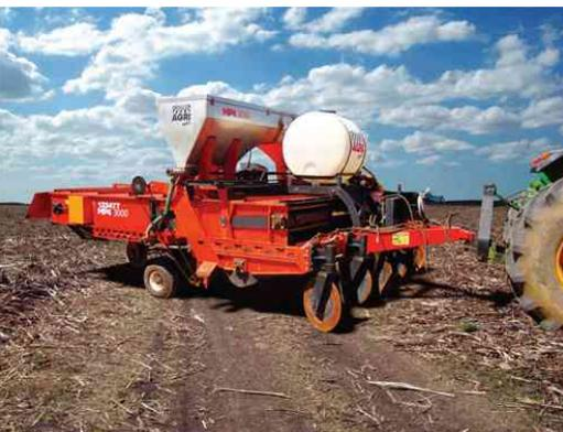
A Agrimec lançou a Linha Canavieira com dois produtos para a preparação do solo na lavoura de cana: o Multicultivador Pulverizador Canavieiro sob Palha e o Cultivador Quebra-Lombo Rotativo com Aplicador de Herbicida. Indicado para o uso na lavoura canavieira pós-colheita, o Multicultivador Agrimec executa quatro operações simultaneamente: subsolagem, adubação e pulverização por debaixo da palha, bem como o enleiramento da mesma ao devolver a palha ao solo.
