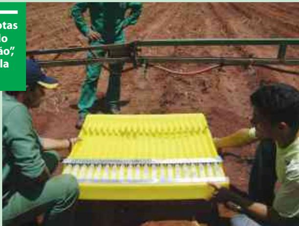
ção são projetadas para uma perfeita deposição de gotas a uma distância de 50 centímetros sobre o alvo. Porém, é recomendado que após a equipagem do pulverizador com bicos (pontas) “novos”, uma avaliação do perfil de distribuição de todos os bicos seja feita, antes do início dos trabalhos de aplicações.
