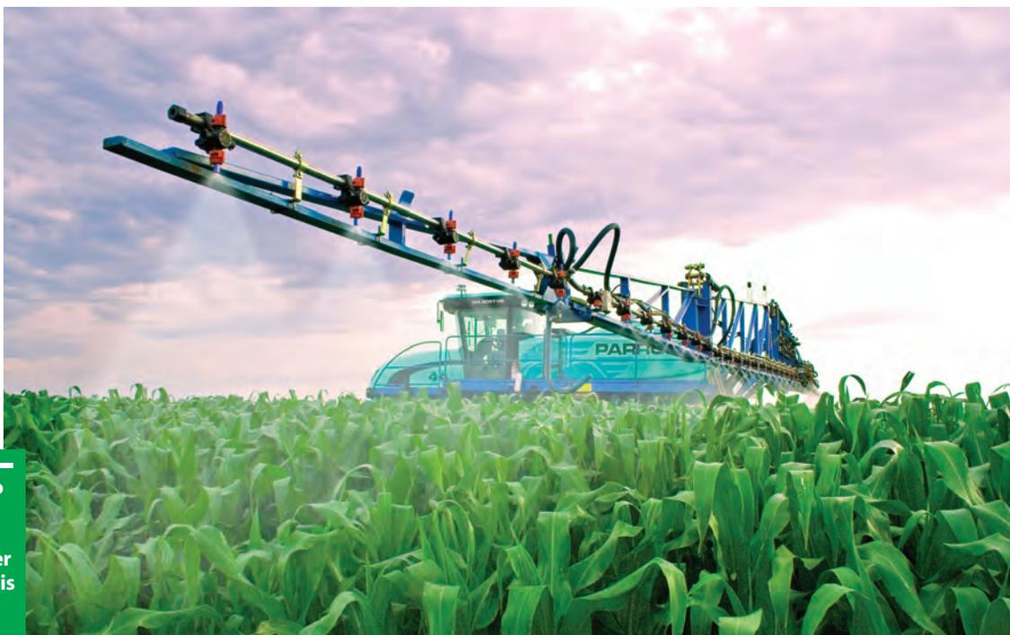
Os autopropelidos são máquinas de alto desempenho e que conseguem desenvolver velocidades operacionais entre 15 a 30 km/h
