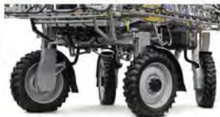
Equipados com motor Mercedes-Bens modelos OM 904 LA de 177 cv e modelo OM 924 LA de 220 cv.
