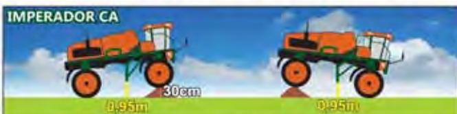
O Imperador CA possui quadro de barras pendular pantográfico com patente mundial que reduz em até 75% os impactos verticais e 30% os movimentos longitudinais.
