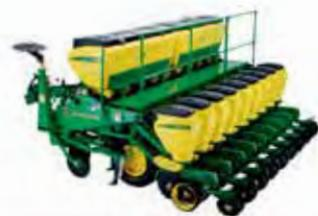
Plantadeira Série 1100 com modelos de 7 linhas (mecânica) e de 3 a 13 linhas (mecânica ou vácuo) com espaçamentos de 40 a 90 cm.
