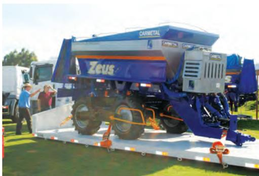
roll-off e uma prancha para transporte de máquinas também com o sistema *roll-on roll-off*, muito trabalhado no Paraná. Já na linha agrícola, o foco foi na apresentação de um exclusivo sistema de interface entre a velocidade da esteira e a abertura da comporta, apresentado nos equipamentos “Zeus 12001 e Zeus 25001” – distribuidores de sementes e fertilizantes, puxados por trator ou caminhão, que possuem uma faixa de aplicação superior aos equipamentos tradicionais.
