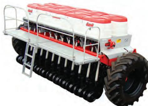
ramentas dianteira e traseira. Essas tecnologias proporcionam o escoamento do adubo ou das sementes. Os depósitos de adubo possuem saídas desencontradas para a otimização dos espaços do chassi e defletores. “Nesta semeadora colocamos um sistema dosador de adubo de alta precisão, permitindo a uniformidade na distribuição e economia de custos com fertilizantes”, destaca.
