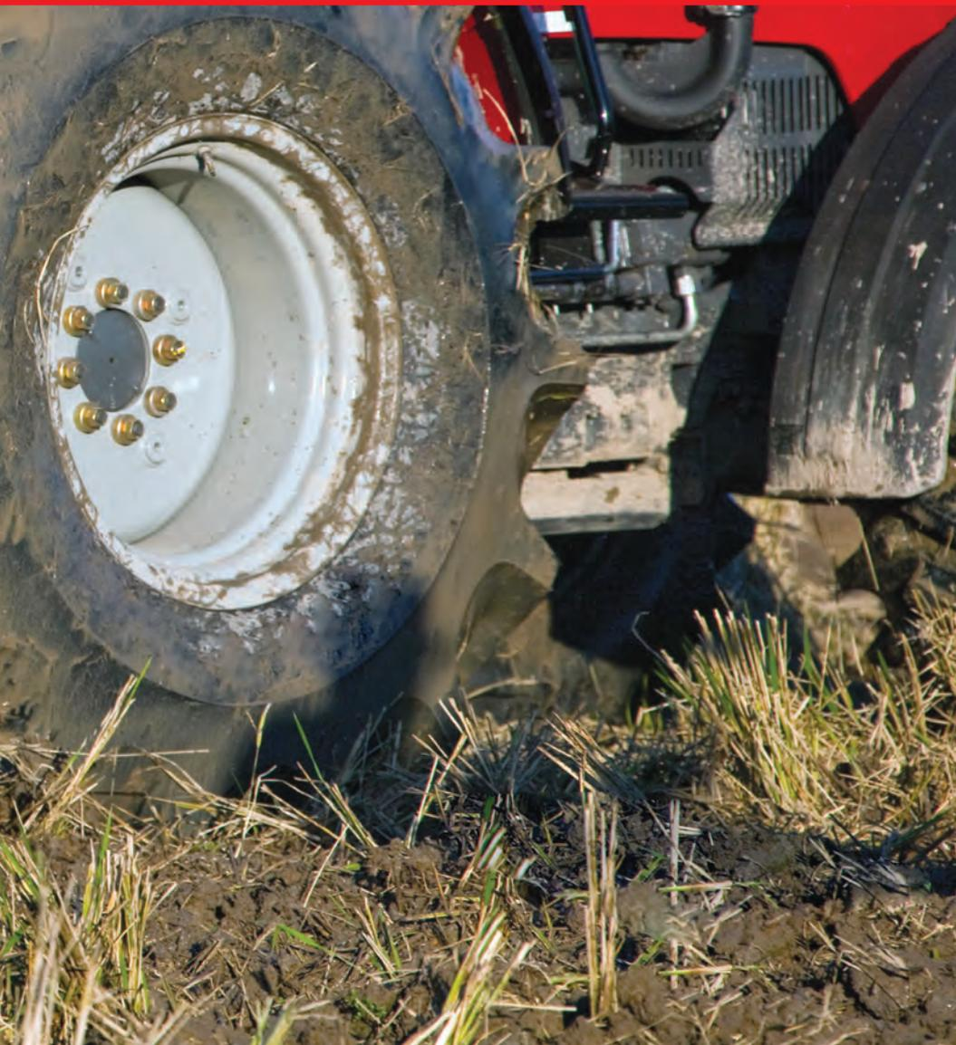
utilização dos pneus é o cuidado para que a pressão interna seja adequada. Os valores de pressão a serem utilizados são recomendados pelos fabricantes, principalmente levando em conta a carga dinâmica sobre eles, o tipo de pneu, o número de lonas e a velocidade de trabalho.
