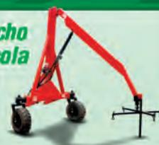
Com elevação máxima de 5,4 metros, carrega e descarrega sacas de grãos de até 2000kg, agilizando o trabalho na lavoura. Com dispositivo de segurança e regulagem de abertura de rodado.
