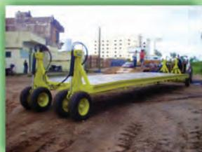
Reboque de transporte de máquinas agrícolas
