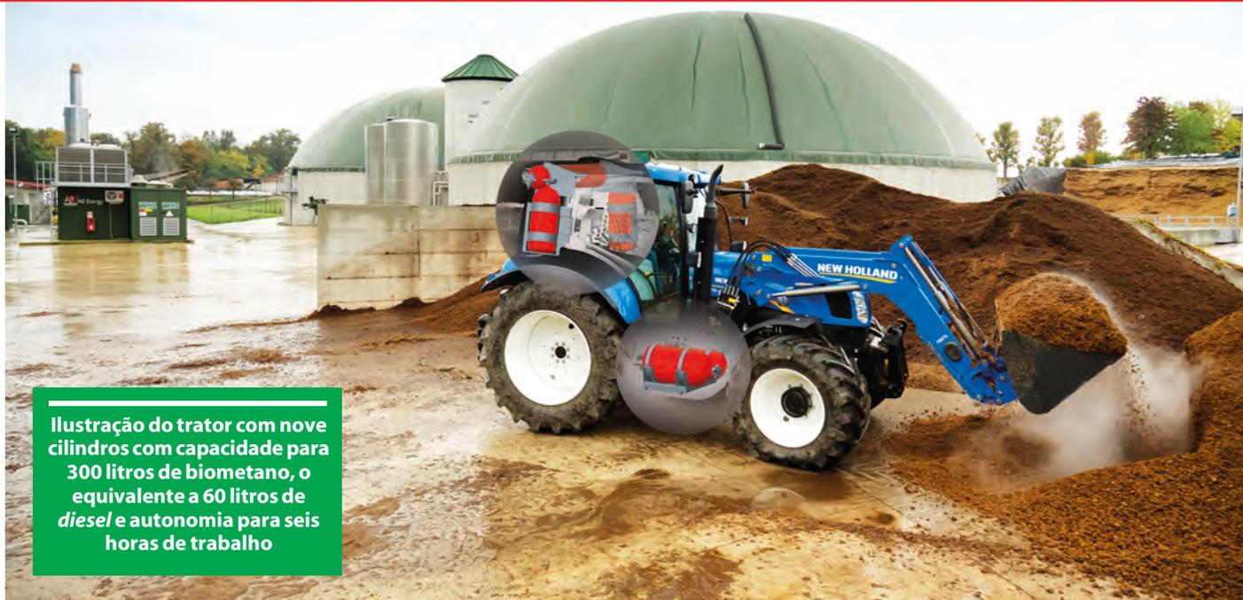
Ilustração do trator com nove cilindros com capacidade para 300 litros de biometano, o equivalente a 60 litros de diesel e autonomia para seis horas de trabalho
