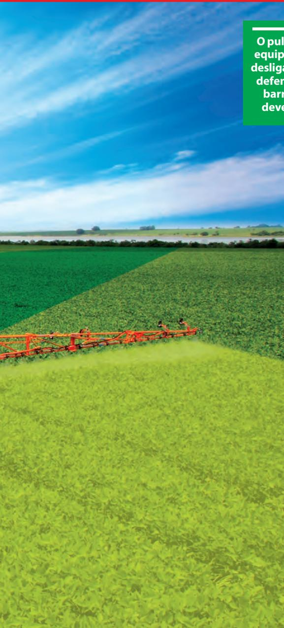
O pulverizador da ilustração é equipado com sistema GPS que desliga cada bico de aplicação de defensivo quando a porção da barra entra na área que não deve ser feita a pulverização
