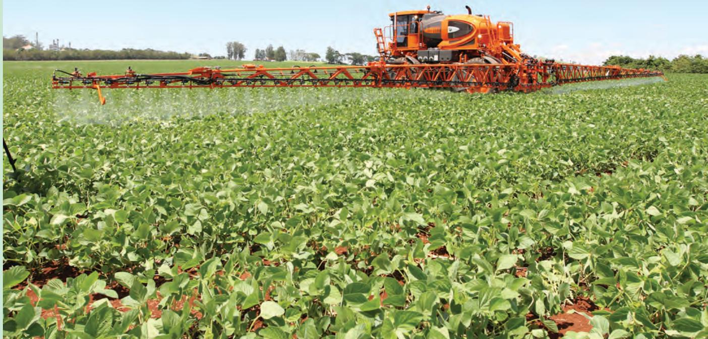
*Uma das principais ferramentas para a qualidade das aplicações é a barra assistida a ar ou Sistema Vortex, que propicia aumento do depósito de produtos nos terços médio e inferior das plantas, reduz o risco de deriva e possibilita a adequação do volume de pulverização com menor quantidade de calda*
