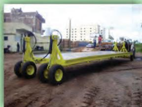
Reboque de transporte de máquinas agrícolas
