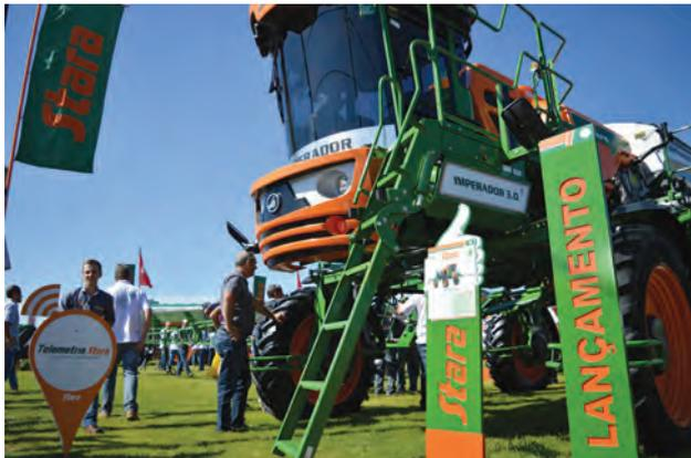
Entre os lançamentos da feira de Não-Me-Toque, a Stara apresentou o Imperador 3.0, um autopropelido que reúne um pulverizador com barras centrais e um distribuidor, podendo realizar as duas operações com o mesmo equipamento em momentos distintos. A inovação promete ao produtor maior eficiência na lavoura, além da redução dos custos operacionais. O Imperador 3.0 permite o parcelamento das aplicações de fertilizantes e de defensivos com a manutenção do mesmo ras-
