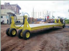
Reboque de transporte de máquinas agrícolas
