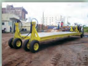
Reboque de transporte de máquinas agrícolas
