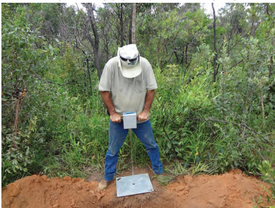
**A importância da avaliação da resistência do solo à penetração pode ser realizada pelo Índice de Cone, definido como a resistência do solo à penetração de uma ponta cônica**
