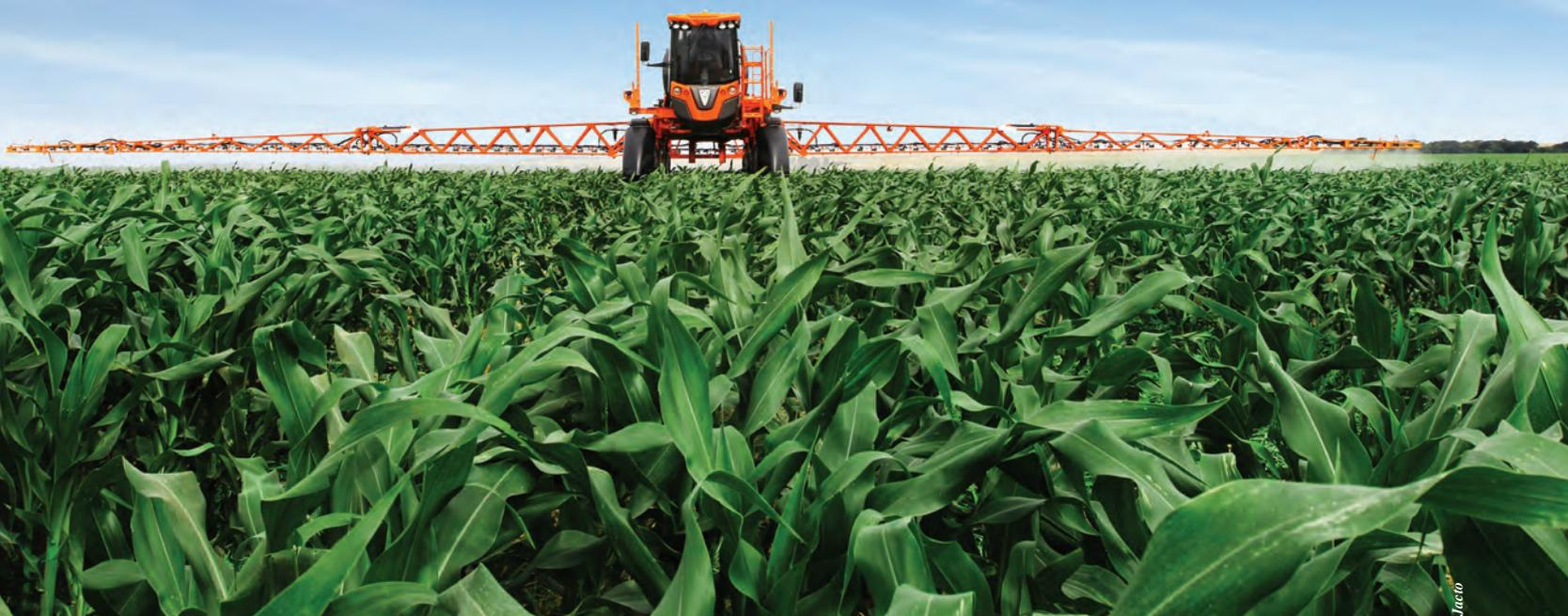
*A telemetria promete uma nova revolução no campo. A cada 5 segundos, o sistema registra as condições de trabalho do pulverizador e envia essas informações a um servidor, o que permite alguém avaliar o desempenho do trabalho em qualquer lugar. Os mapas descrevem todas as ações da máquina*
