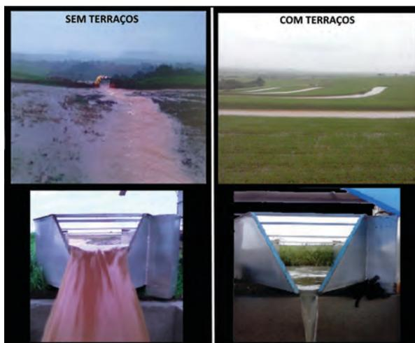
Imagens dos efeitos de bacias pareadas "com" e "sem" terraços demonstra que a bacia com terraceamento reduz significativamente as perdas de água, além da redução da erosão
