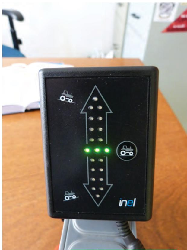
O dispositivo é colocado sobre o trator, no campo de visão do tratorista e, por meio de uma barra de luzes (sinais luminosos), indica ao operador qual ação deve tomar
