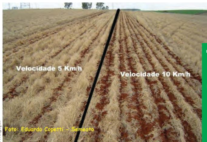
**Uma semeadora de plantio direto deve promover o revolvimento mínimo do solo, e os equipamentos devem cortar a palha sobre a superfície do solo, evitando assim embuchamento nos demais componentes**
