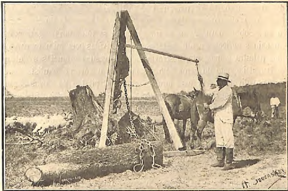
Arrancador de tocos empregado em um terreno destinado ao plantio do arroz na fazenda — Novo Horizonte
