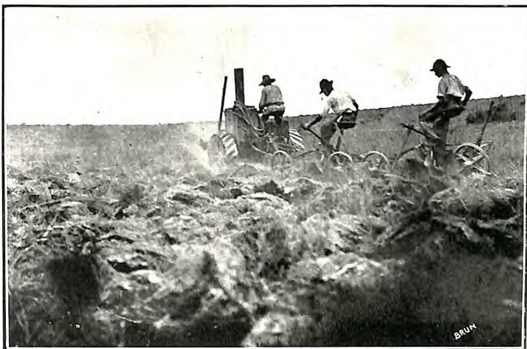
AUTOMOVEL AGRICOLA PUXANDO DUAS CHARRUAS DE DISCO
