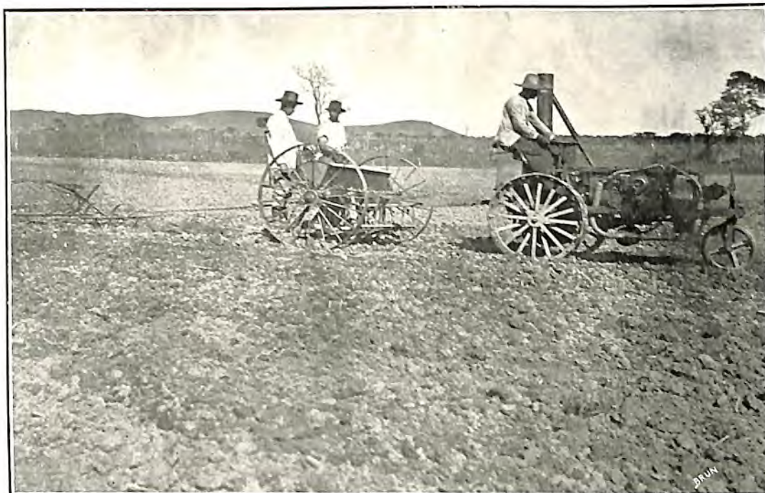
AUTOMOVEL AGRICOLA PUXANDO UM SEMEADOR DE ARROZ
