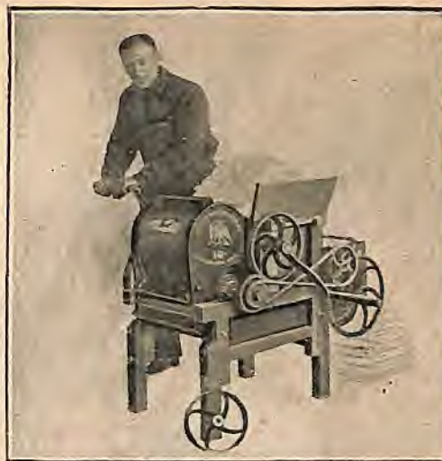
Descaroçador de algodão á mão com serras de 10 polegadas, com alimentador e condensador
