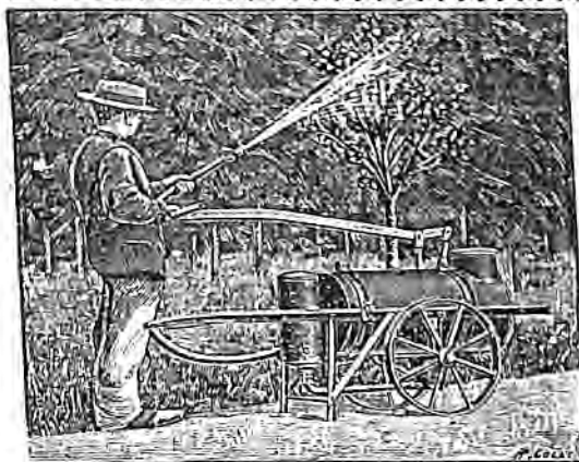
Bomba para pulverização e incendio
