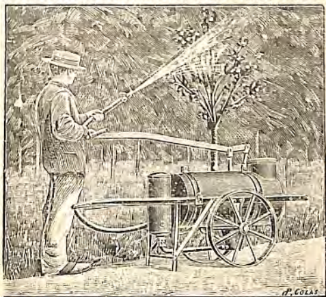
Bomba para pulverização e incendio
