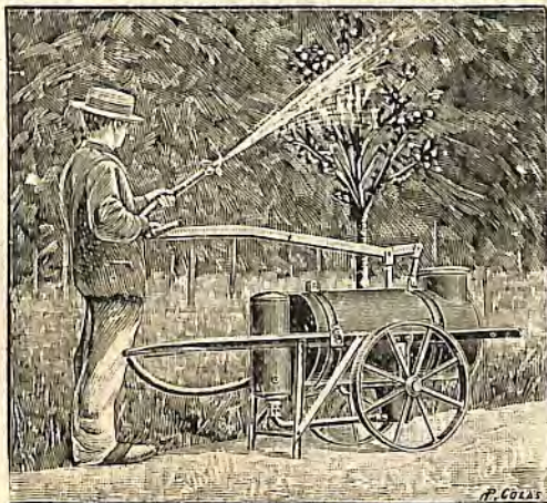
Bomba para pulverização e incendio
